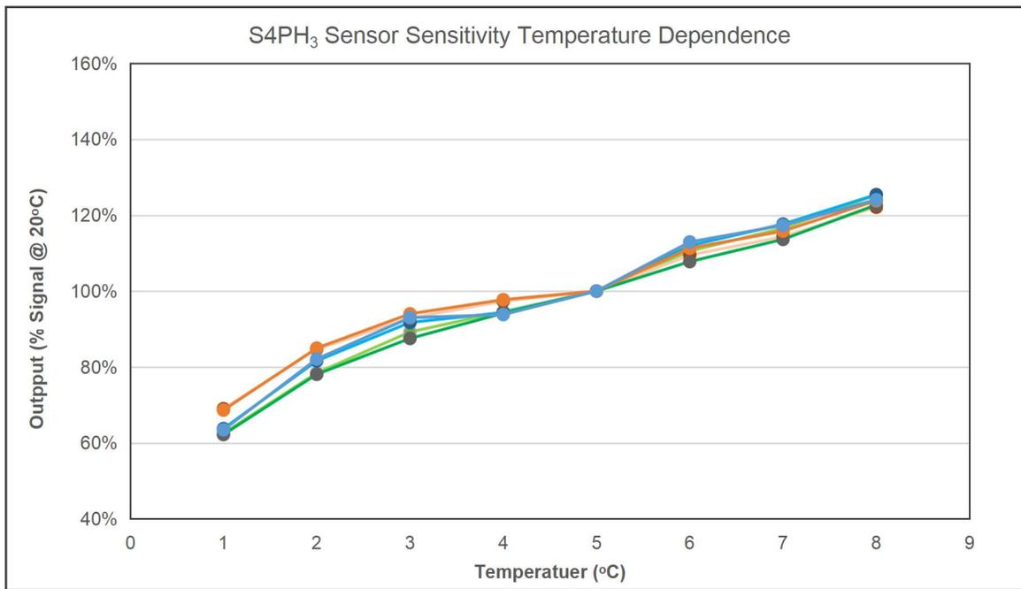
S4PH<sub>3</sub> 磷化氢传感器灵敏度的温度依赖性曲线
