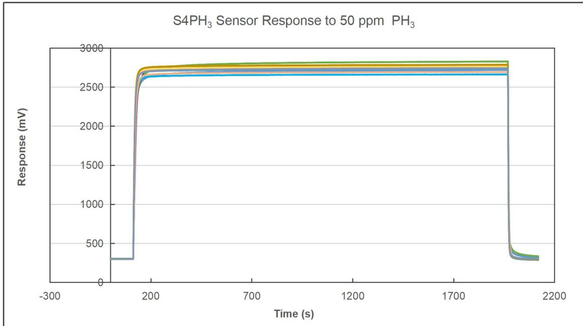
S4PH<sub>3</sub> 磷化氢传感器的响应恢复曲线
