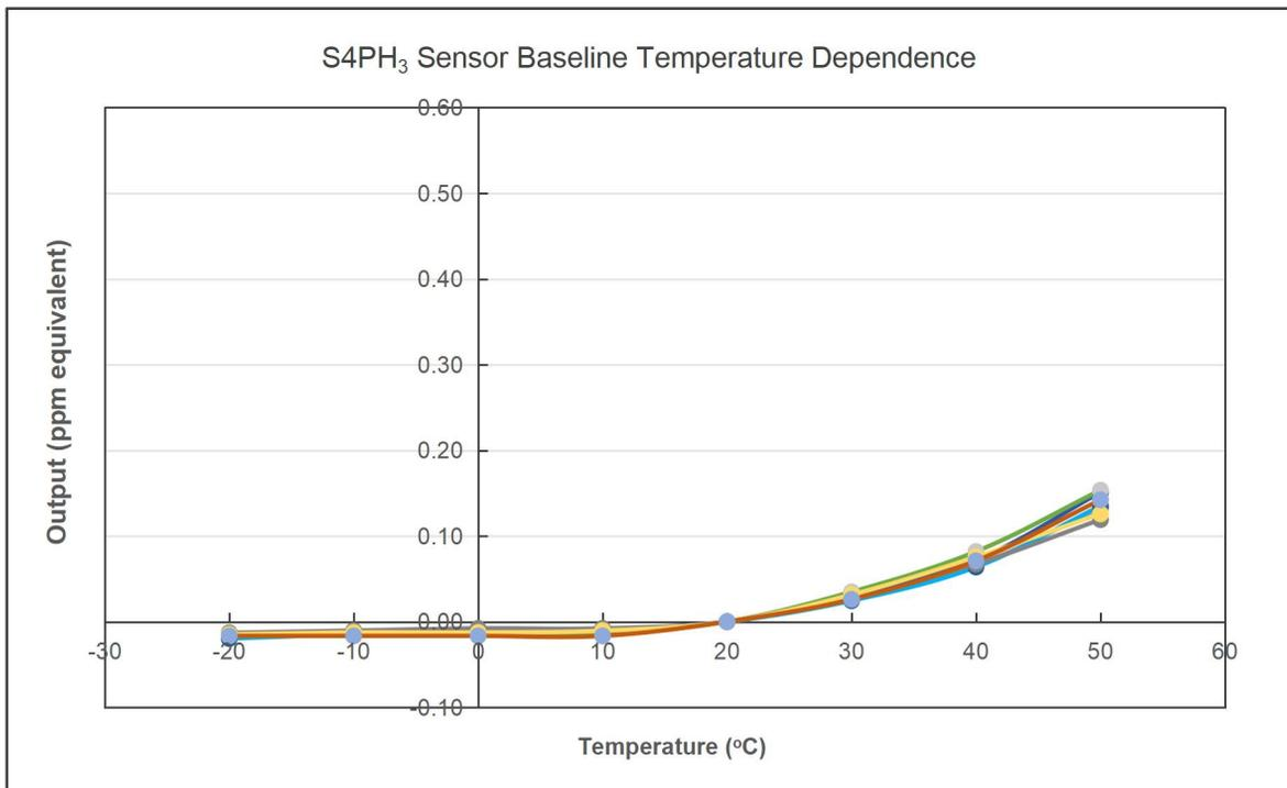
S4PH<sub>3</sub> 磷化氢传感器基线的温度依赖性曲线
