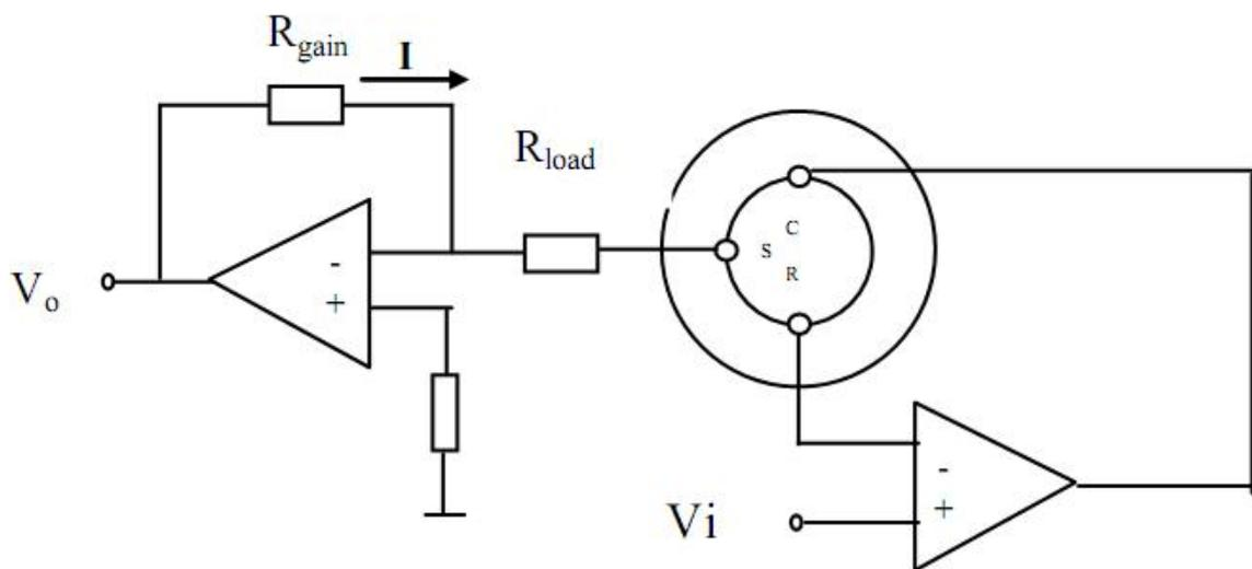
S4PH<sub>3</sub> 磷化氢传感器的基本测试电路
